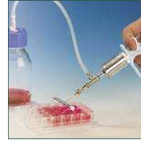
Aspiración con válvula en modo invertido
