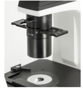
N.A. 0,3 Abbe Condenser with phase contrast slide
