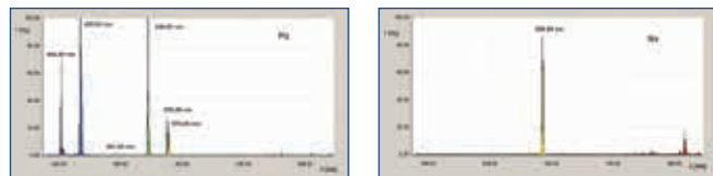
Espectros de linhas de Hg (alta pressão) e Na, registrados com o espectrômetro digital
