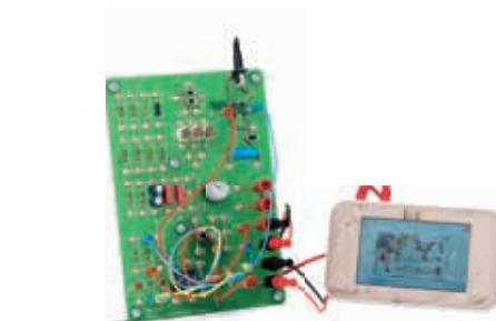
Curva característica de um diodo Z
