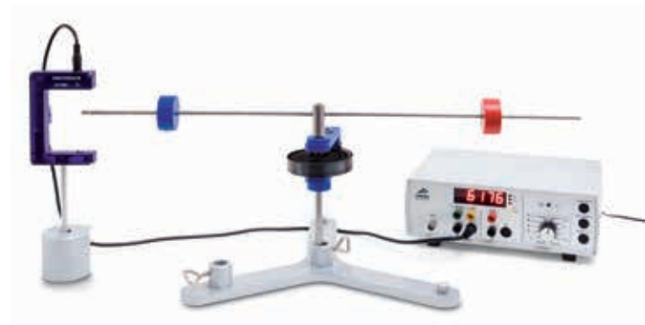
Momento de inércia J dos corpos de massa em dependência do quadrado da distância r das massas
