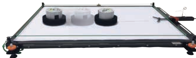
Exemplo de experiência: Choque elástico
