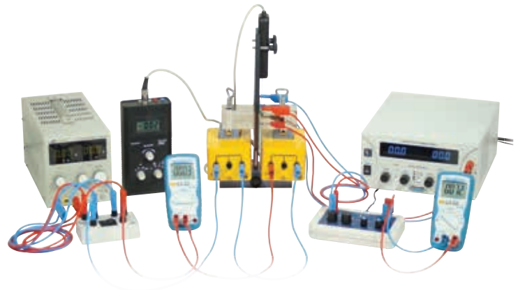
Montagem do experimento: Efeito Hall em metais
