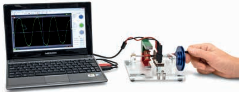
Operação como gerador de AC
