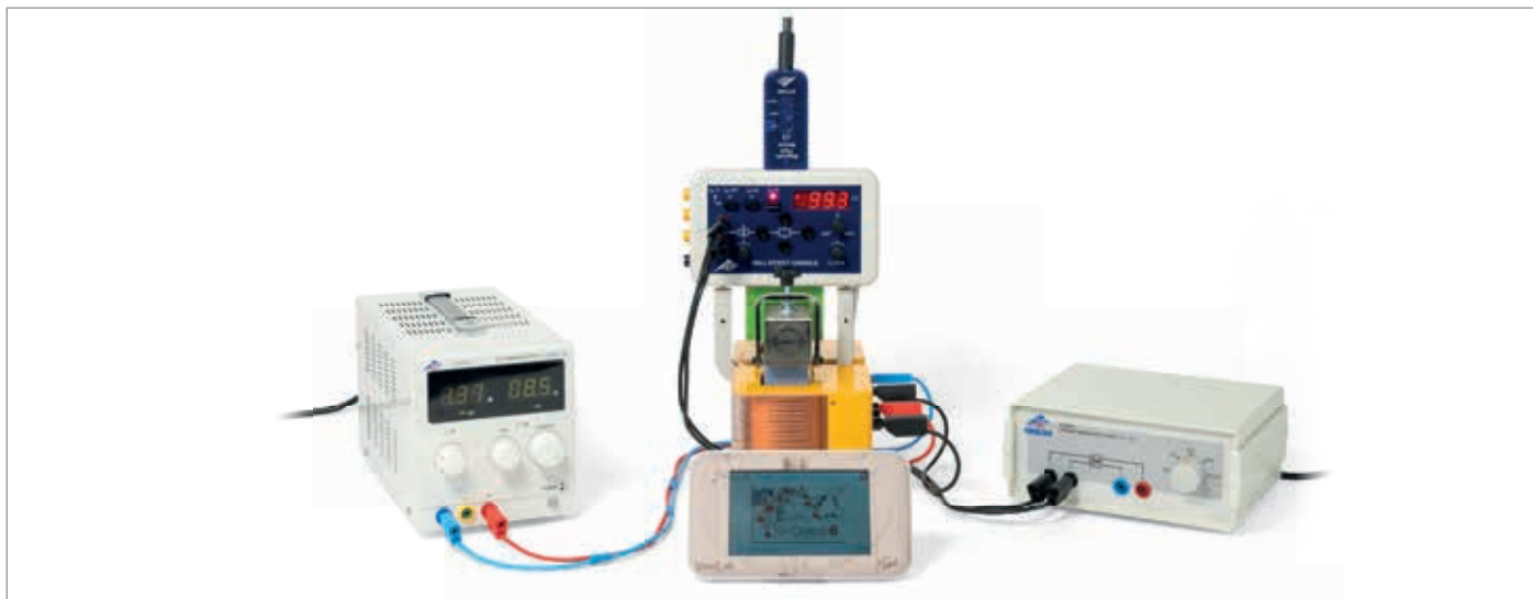
Tensão de Hall em germânio com dopagem tipo p e tipo n como função da temperatura T
