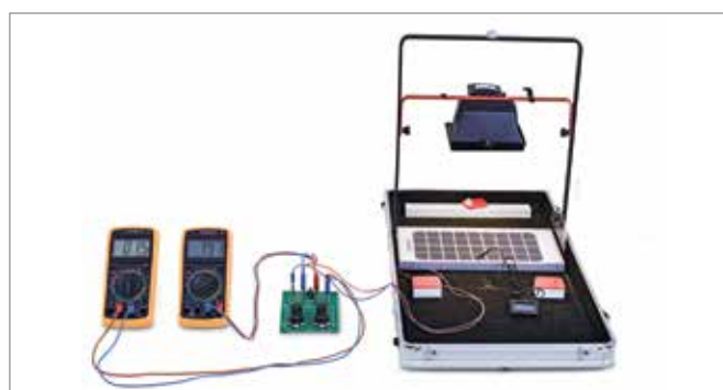
Dependência da temperatura da potência de módulos solares
