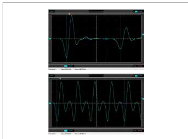
Fig. 3: Propagação de impulso sonoro, (em cima: haste de PVC, 200 mm, em baixo: haste de vidro, 200 mm), sinal na extremidade oposta à excitação da haste (ciano)
