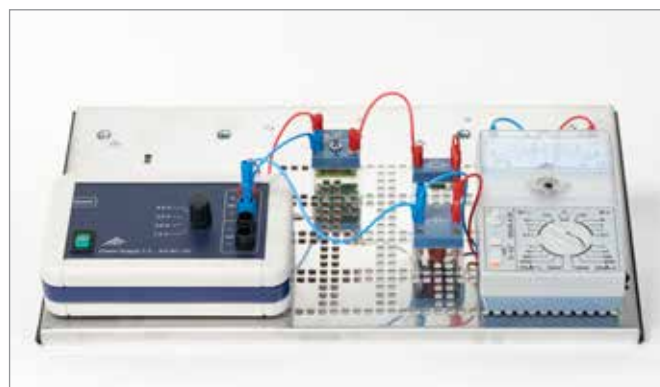
Carga e descarga de um capacitor (tensão)
