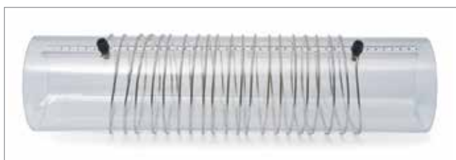
Fig. 1: Bobina com densidade de espiras variável
