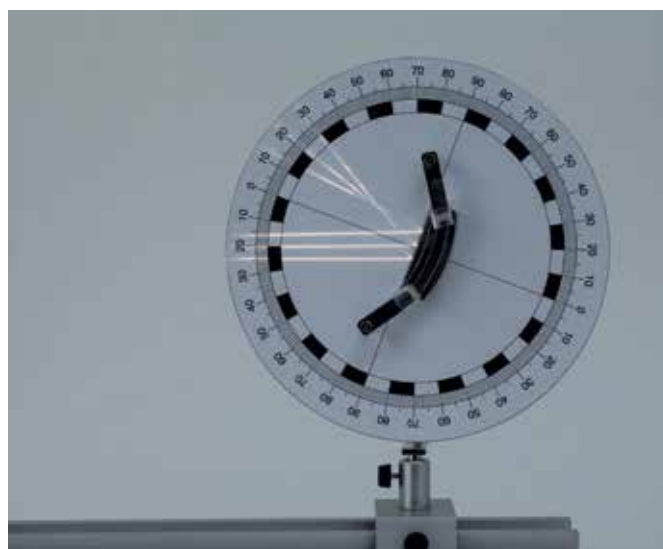
Fig. 3: Reflexão de três raios paralelos em espelho côncavo
