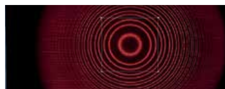
Fig.3.: Efeito Zeeman longitudinal: observação da divisão em dupla da linha vermelha de cádmio em um campo magnético externo.
