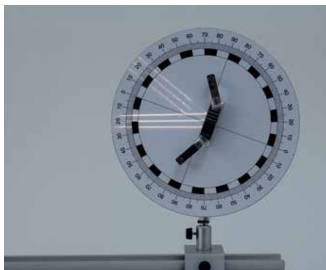
Fig. 2: Reflexão de três raios paralelos em espelho plano
