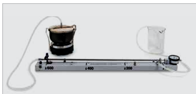
Fig. 3: Montagem com gerador de vapor
