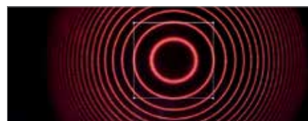
Fig. 2: No campo magnético externo: observação dos anéis de interferência da linha vermelha de cádmio criados pelo etalon de Fabry-Pérot. Como um auxílio de orientação, o segundo anel de interferência a partir do centro é indicado com um quadro.
