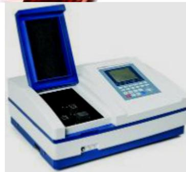
Espectrofotômetros UV/VIS de feixe duplo e outros
