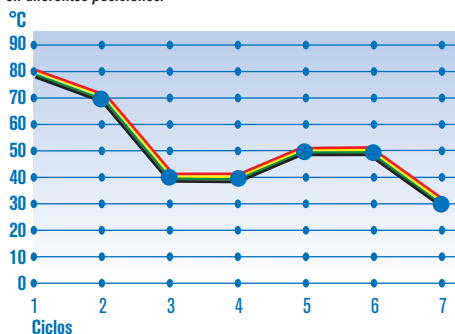
Gráfico que muestra la perfecta uniformidad de la temperatura en los diferentes pocillos del bloque que se distinguen por los colores rojo, amarillo, verde y negro y como se mantiene la uniformidad durante los periodos del ciclo térmico previamente programados en pantalla.
