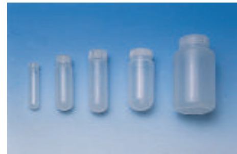
Tubos COMECTA en polipropileno translúcido. Autoclavables.
