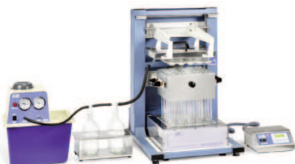
Bomba de recirculación "Scrubber" Bloque digestor
