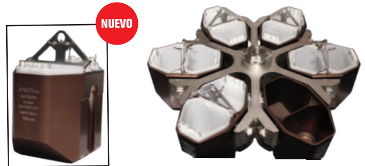
Imagen de la centrífuga con cabezal y vasos con doble compartimento para bolsas de sangre triples o cuádruples de 500 a 800 ml.
